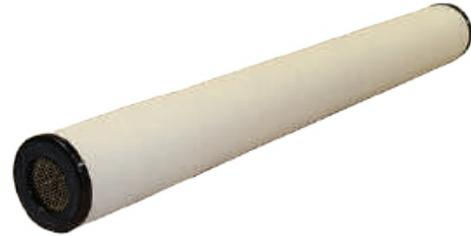
El tubo de medios está hecho de materiales específicamente diseñados para mejorar el proceso de coalescencia y está soportado por un núcleo de metal perforado. Una tapa metálica con un agujero de perno cubre un extremo. El cartucho está envuelto externamente con un calcetín de algodón para el drenaje adicional de agua coalescente.
