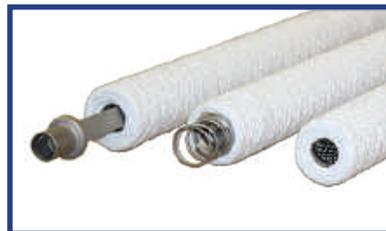
El material de fibra como el algodón, el polipropileno o la fibra de vidrio se enrolla alrededor de un núcleo central para las necesidades de filtración deseadas. El núcleo se ofrece en varios materiales para satisfacer la aplicación. Suministrado por separado, el acero inoxidable 304 es el material estándar para el hardware de instalación, incluyendo el ensamblaje de resorte y copa para el extremo superior de retención y el poste y pedestal para el extremo inferior de la lámina de tubo.
